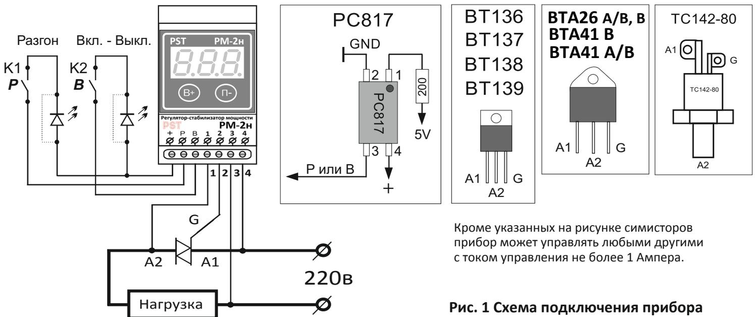
Рис. 1 Схема подключения прибора
